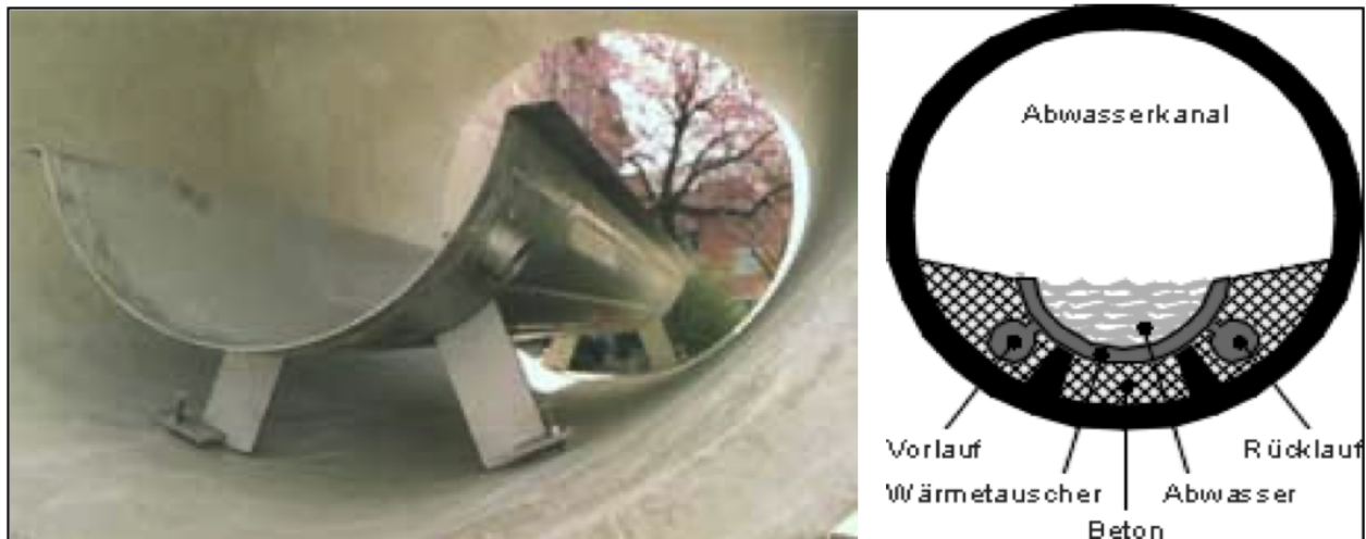
Abb. 19: Rinnenwärmetauscher für Kanäle mit Kreisprofil
